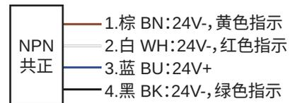
接线方式-IO控制(七色)
